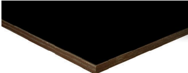
Film haut de gamme (400 g/m<sup>2</sup>) permettant de multiples réutilisations. Il est utilisé pour le coffrage de béton. Conforme à la classe 3 de la norme EN 636.
